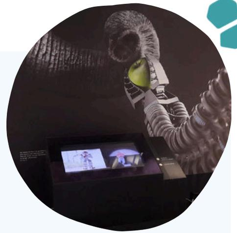
Jeder Apfel ist unterschiedlich groß. Daher ist es schwierig, einen Roboter-Greifarm auf eine feste Apfelgröße einzustellen. Zu große Äpfel könnten zerquetscht werden, zu kleine einfach durchfallen. Der Roboter-Greifarm der Firma Festo passt sich perfekt allen Apfelgrößen an.
